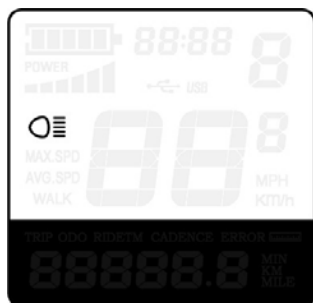
Interfaccia della modalità di illuminazione.
