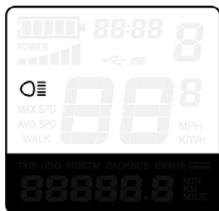
Interfaccia della modalità di illuminazione.
