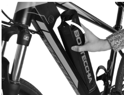
Instalación de la batería
